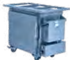
11527 Etuve électrique petit modèle 220/230 V - 16 A monophasé - 2 kW Température maxi 150°C en 30 min - Combiné adaptable pâtisserie ou gastronorme 1/1. Fourni avec 5 grilles pâtisseries 60 x 40 cm. Espace entre les grilles : 7 cm. Ext. : L 89 ; P 50,5 ; H 73 cm. Int. : L 60 ; P 40 ; H 45,5 cm
