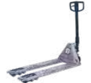
1102 Transpalette L 155 ; l 53 cm. Hauteur du bras de traction : 123 cm. Support bras de levage : 2 roues caoutchouc. Support de fourches : 4 roues nylon. Capacité de levage : 2 t. 65 Kg
