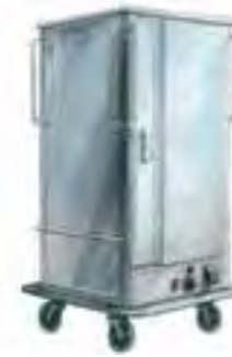
411 Etuve ventilée humidifiée 8 grilles 220 V / 16A monophasé - 2,2 kW. Température maxi : 150 °C en 50 min. Livrée avec 8 grilles gn 2/1 (65 x 53 cm). Espace entre les grilles : 10,5 cm. Bloc de ventilation surmonté d'un bac gn 2/1 et d'un Z antivague. Ext. : L 77 ; l 93 ; H 162 cm. 135 Kg
