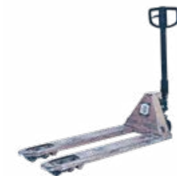
1102 Transpalette L 155 ; I 53 cm. Hauteur du bras de traction : 123 cm. Support bras de levage : 2 roues caoutchouc. Support de fourches : 4 roues nylon. Capacité de levage : 2 t. 65 Kg
