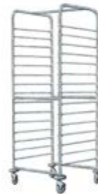
557 Echelle pâtissière Livrée avec 15 grilles pâtissières 60 x 40 cm. Espace entre les grilles : 8 cm. Ext. : L 67 ; I 45 ; H 171 cm. 37 Kg
