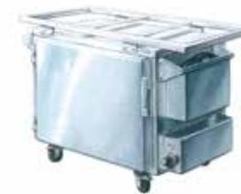
11527 Etuve électrique petit modèle 220/230 V - 16 A monophasé - 2 kW Température maxi 150°C en 30 min - Combiné adaptable pâtisserie ou gastronome 1/1. Fourni avec 5 grilles pâtisseries 60 x 40 cm. Espace entre les grilles : 7 cm. Ext. : L 89 ; P 50,5 ; H 73 cm. Int. : L 60 ; P 40 ; H 45,5 cm
