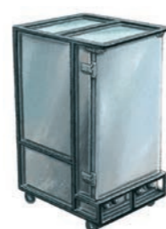
0409 / 0229 Etuve morice mixte Livrée avec 8 grilles. Espace entre les grilles : 8 cm. Ext. : L 74 ; I 96 ; H 135 cm. Int. : L 60 ; I 80 ; H 95 cm. 143 Kg Gaz (0229) : 1 bouteille de gaz butane (20 Kg). Détendeur de 28 mbar. Équipée d'une sonde thermostatique pour le gaz, les rampes se coupent à 180°C et se rallument à 160°C. Electrique (0409) : 220 V / 16A monophasé - 4,5 kW. Répartis entre 2 prises (1,5 kW et 3 kW)
