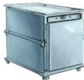
10024 Etuve électrique ventilée 16 grilles Electrique 220 V / 16A monophasé - 3,6 kW. 1 prise. Température maxi : 200°C en 90 min. Livrée avec 16 grilles pâtisseries. Ext. : L 79 ; I 125 ; H 130 cm. Int. : L 60 ; I 80 ; H 85 cm. 217 Kg
