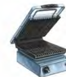
0476 Grill à panini 220 V / 16 A monophasé - 2,2 kW. Réglage thermostatique. Ext. : L 40 ; l 28,5 ; H 26 / 47 cm (position levée). Plaque L 24,5 x P 20 cm. 15 Kg
