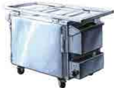
ETUVE ÉLECTRIQUE PETIT MODÈLE 1 1 5 2 7 220/230 V - 16 A monophasé - 2 kW Température maxi 150°C en 30 min - Combiné adaptable pâtisseries ou gastronorme 1/1. Fourni avec 5 grilles pâtisseries 60 x 40 cm. Espace entre les grilles : 7 cm. Ext. : L 89 ; P 50,5 ; H 73 cm. Int. : L 60 ; P 40 ; H 45,5 cm
