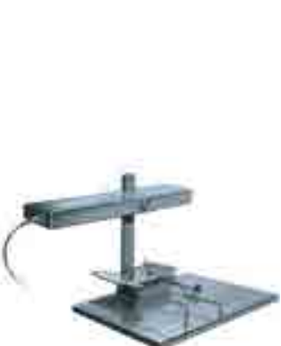
APPAREIL À RACLETTE 1 9 3 7 8 220 V - 16A - 900 W Ext : L 26,5 ; l 53 ; H 25 cm mini et 40 cm maxi. Réglage de la hauteur du boîtier de chauffe par crémaillère. Cuisson très rapide de 30 à 45 sec. environ. Est composé d'un socle, d'un axe, d'une résistance et d'un cordon d'alimentation. 3,70 Kg
