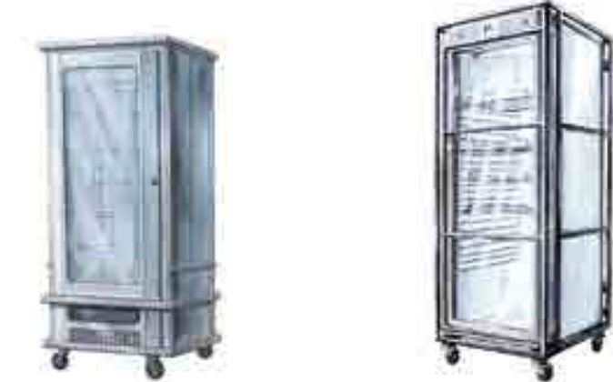
ARMOIRE RÉFRIGÉRÉE VENTILÉE 0 4 4 5 220 V / 16A monophasé - 320W. + 1 à + 4° C. Livrée avec 5 grilles gn 2/1 (65 x 53 cm). Ext. : L 76 ; l 94 ; H 186 cm. Int. : L 56 ; l 67 ; H 115 cm. 146 Kg
