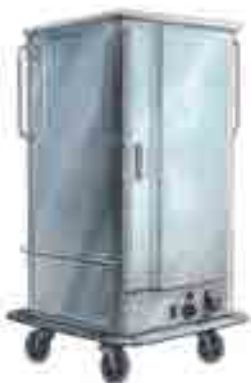
ÉTUVE VENTILÉE HUMIDIFIÉE 8 GRILLES 0 4 1 1 220 V / 16A monophasé - 2,2 kW. Température maxi : 150 °C en 50 min. Livrée avec 8 grilles gn 2/1 (65 x 53 cm). Espace entre les grilles : 10,5 cm. Bloc de ventilation surmonté d'un bac gn 2/1 et d'un Z antivague. Ext. : L 77 ; l 93 ; H 162 cm. 135 Kg
