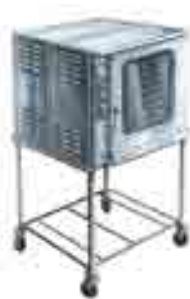
FOUR VENTILÉ HUMIDIFIÉ 0 3 9 7 380 V / 32A triphasé + neutre 16 kW - Prise P 17. Réservoir d'eau autonome, capacité 3 L. Réglage du thermostat de 50 à 270°C. Fourni avec 10 grilles gn 1/1 (53 x 32,5 cm). Espace entre les grilles : 6 cm. Ext. : L 96 ; l 108 ; H 165 cm. Int. : L 69 ; l 41 ; H 53 cm. 180 kg
