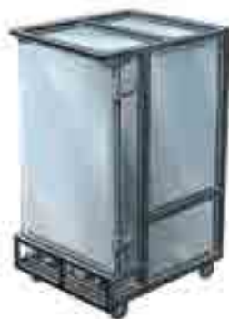
ÉTUVE MORICE MIXTE 0 4 0 9 / 0 2 2 9 Livrée avec 8 grilles. Espace entre les grilles : 8 cm. Ext. : L 74 ; l 96 ; H 135 cm. Int. : L 60 ; l 80 ; H 95 cm. 143 Kg Gaz (0229) : 1 bouteille de gaz butane (20 Kg). Détendeur de 28 mbar. Équipée d'une sonde thermostatique pour le gaz, les rampes se coupent à 180°C et se rallument à 160°C. Electrique (0409) : 220 V / 16A monophasé - 4,5 kW. Répartis entre 2 prises (1,5 kW et 3 kW)
